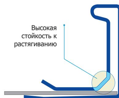
Вышеуказанные критерии определяют эксплуатационные характеристики, качество и внешний вид Вашего воздуховода. Таким образом, не все соединения воздуховодов прямоугольного сечения изготавливаются одинаковыми!
