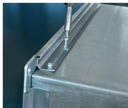
Прямоугольные воздуховоды, собранные с применением технологии Snap Lock, соответствуют классу плотности "В" по Eurovent 2.2. Для достижения повышенной плотности воздуховодов класса "С" нанесите перед сборкой в швы воздуховодов герметик.
